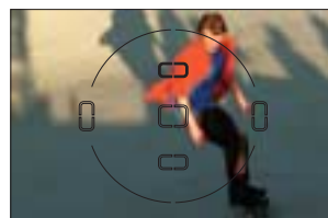
Dynamische AF: Scherpstelling blijft gehandhaafd op het onderwerp door het scherpstelveld automatisch aan te passen wanneer het onderwerp uit het geselecteerde veld verdwijnt.
